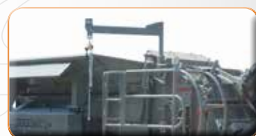
Ramię do wymiany młotków udarowych (tylko dla modelu R900)
