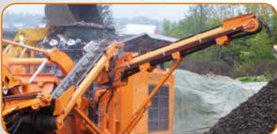
pozycja robocza - wyładunek na przymę
