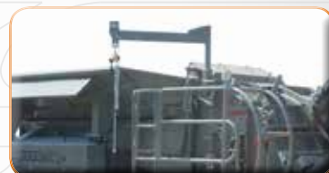
Ramię do wymiany młotków udarowych R700
