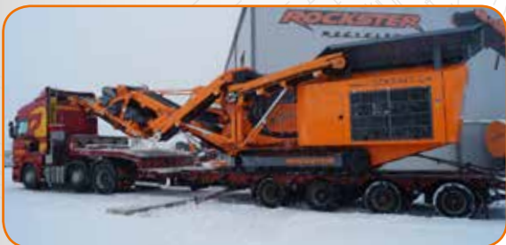
Transport - skrzynia przesiewająca i taśmociąg powrotny
